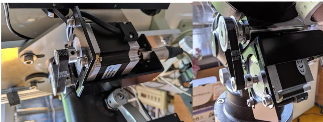
赤緯モーターユニットは極軸望遠鏡の接眼部側から見て右側にプーリーがくるように取り付けます。
