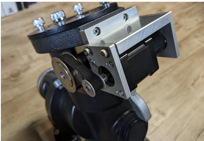
赤緯モーターユニットは極軸望遠鏡の接眼部側から見て右側にプーリーがくるように取り付けます。
