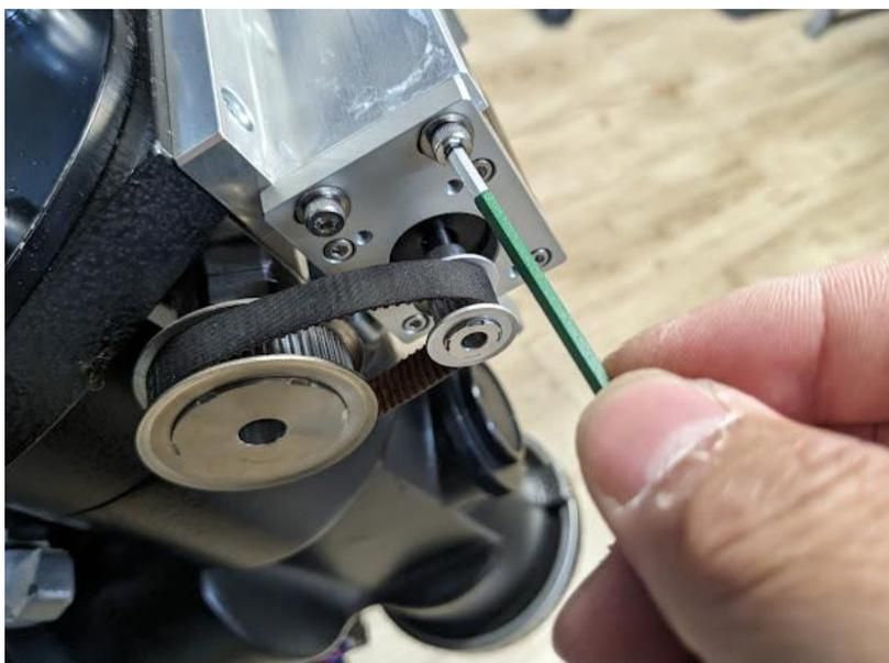
モーターの固定ねじを緩めベルトがピンと張るように調整し固定ねじを締めます
