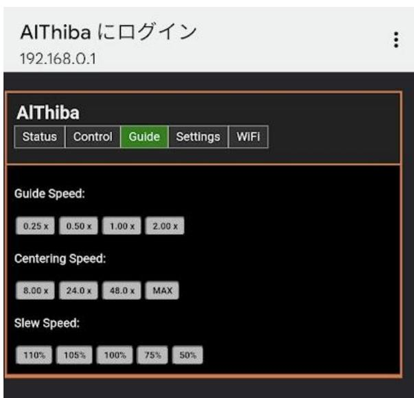
GuideSpeed: ガイドスピードの変更とセンタリングスピードの変更が出来ます。
