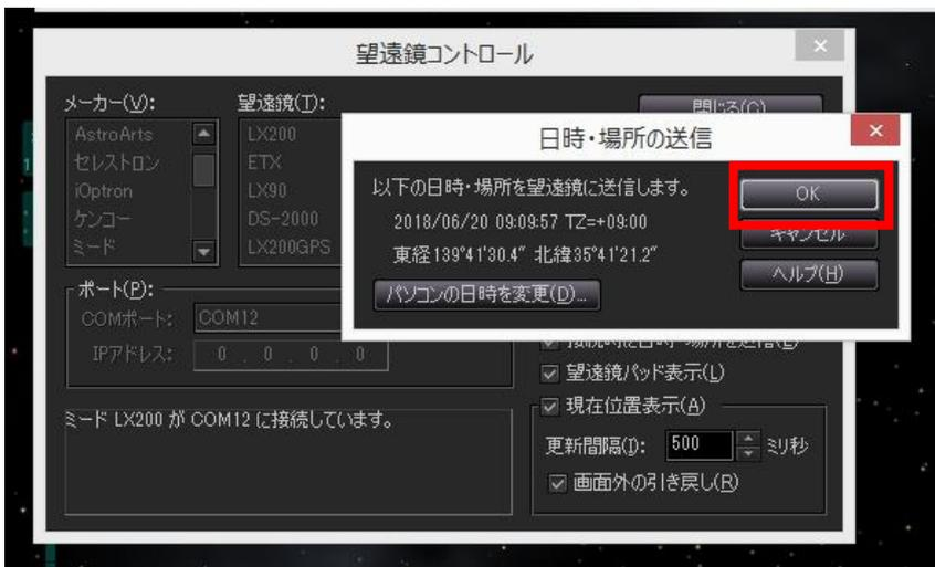
日時・場所の送信を選択しコントローラーの日時・場所を設定します。
